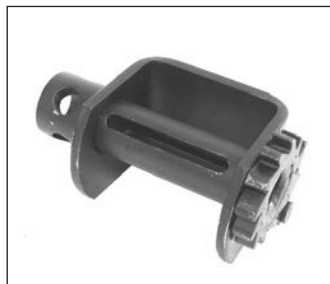
# 784-7438 Treuil étroit à souder Pour courroie de 2", 3" et 4" Charge de travail maximale: 2 500 kg / 5 500 lb
