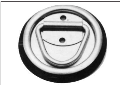
# 783-1043 Coupe encastrée en acier zingué avec un espaceur en plastique. Peut être utilisé sans l'espaceur pour être encastré. Charge de travail maximale: 181 kg / 400 lb
